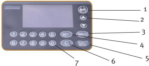
1. Druckertaste: Ausdruck der Zählergebnisse, lang: Öffnen des Einstellmenüs der Echtzeituhr
