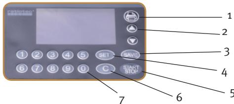
1. Tecla de impresión: Imprimir los resultados de conteo. Mantener: Abrir el menú de ajustes del reloj de tiempo real.
