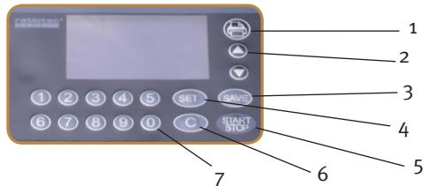
1. Touche IMPR.: Impression des résultats de comptage, pression longue: ouverture du menu de l'horloge temps réel
